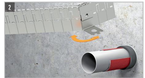
Das Metallband durch abzählen der notwendigen Metallbandglieder gemäß Tabelle mit Hilfe eines Befestigungshaken abknicken. Den Haken dabei in das Metallband oben einhängen und darauf achten, dass der Haken auf der linken Seite mit dem Metallband bündig abschließt. Metallband durch hin und her bewegen abbrechen, somit ist kein weiteres Werkzeug notwendig.
