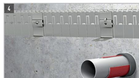
Die Haken an den entsprechenden Positionen einhängen, die um 90° umgebogene Lasche durch die Öffnung führen und zurück biegen, sodass der Haken fest sitzt.
