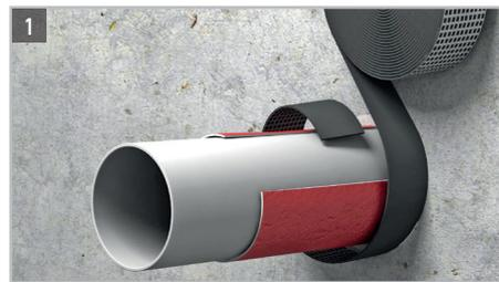
Die Manschette darf um isolierte oder unisolierte Rohre installiert werden. Das 40 mm breite intumeszierende Band in entsprechender Lagenanzahl, je nach Rohrdurchmesser um das Rohr bzw. die Isolierung wickeln. bei selbstklebender Ausführung die Schutzfolie abziehen und die einzelnen Lagen miteinander verkleben.
