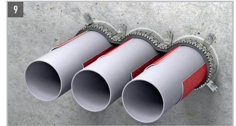
Sonderanwendung: Mehrfachdurchführung von bis zu 3 nebeneinander liegenden Rohren (PVC, PE und PP) mit einem Rohraußen-durchmesser von  $\leq 75$  mm. Der Abstand von Rohr zu Rohr darf dabei max. 15 mm betragen.
