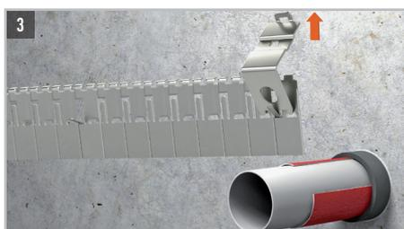
Die lange Nase des Hakens in die lange Nase des Bandes einführen und durch Herunterdrücken des Hakens und abschließendes Umbiegen der Nase um 90° die jeweiligen Befestigungspunkte festlegen.
